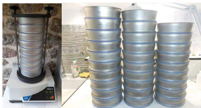
Figure 11 : (Gauche) tamiseuse Retsch AS200 basic ; (Droite) tamis AFNOR
