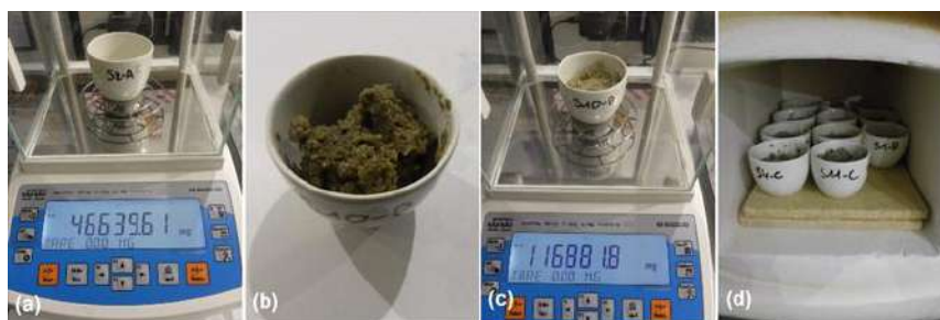
Figure 12 : (a) pesé creuset vide ; (b) intégration sédiment humide ; (c) pesé après séchage 24 à 48h00 ; (d) mise en calcination à 450°C pendant 4h00
